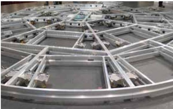
1. La estructura debe instalarse siempre dejando una altura mínima de 3 / 5 cm para poder pasar el cableado sin que este interfiera entre las ruedas del giratorio y de los motores.
